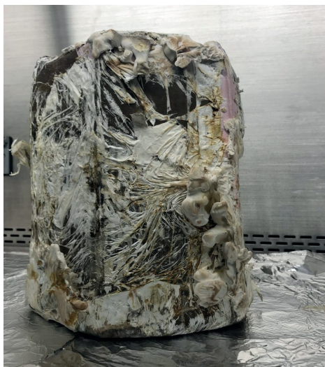
8. sz. ábra: Kezdetleges építmény („MushRoom” 24 ) kéthetes növesztés után (Kép: 2018 Stanford-Brown-RISD iGEM Team)
